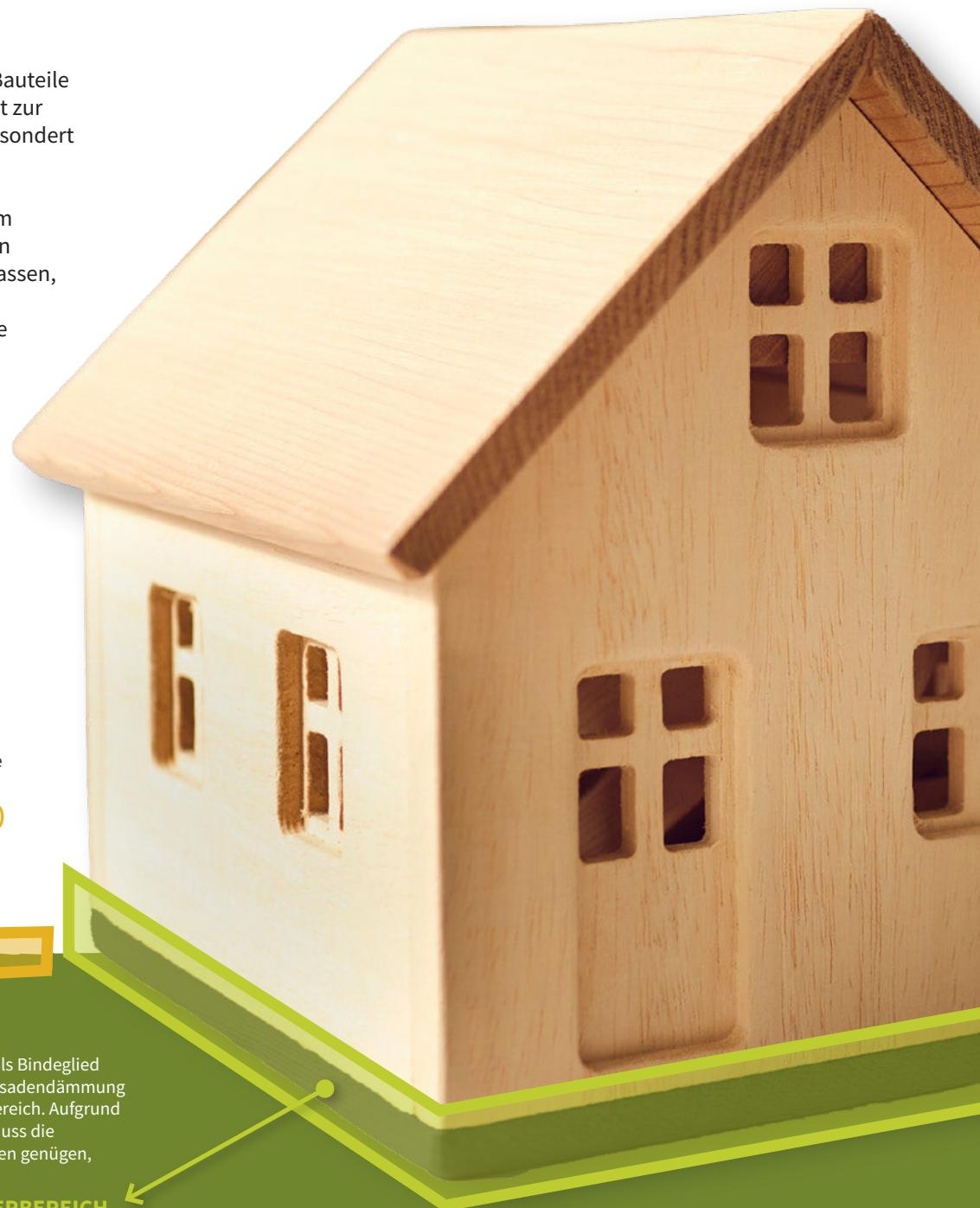
Die Geländeoberkante ist die fertige Oberfläche des umgebenden Geländes und dient als Bezugsebene für die Höhenlage von Bauteilen.
